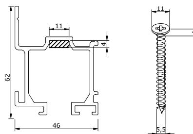
NOTA : Afin de respecter l'encombrement maximal, les têtes de vis doivent avoir un Ø de 11mm max et une hauteur max de 4 mm (hors fraisage).
