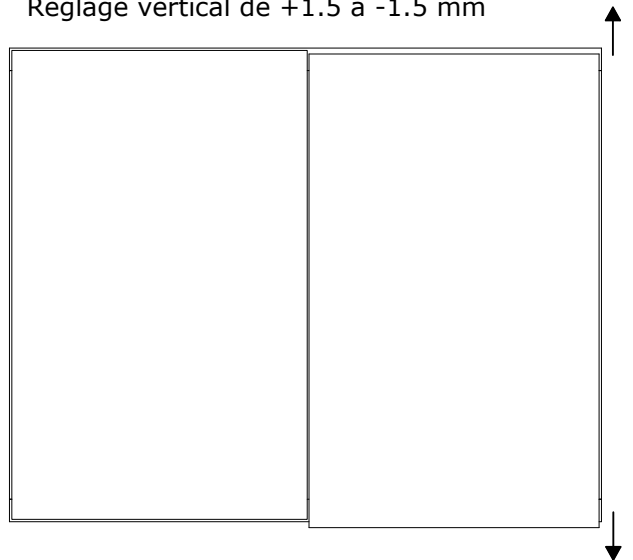
Réglage vertical de +1.5 à -1.5 mm
