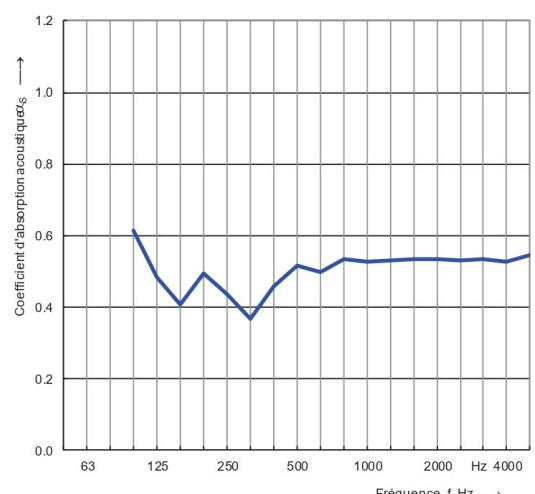
Coefficient d'absorption acoustique  $\alpha_w$  évalué selon la norme ISO 11654
